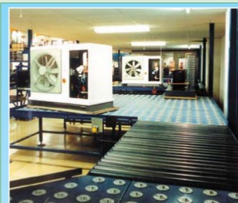
Kuličkové stoly jako součást montážní linky
