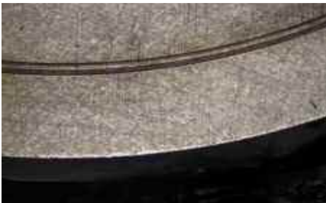
Einlaufrille nach 24 Stunden Run-in groove after 24 hours
